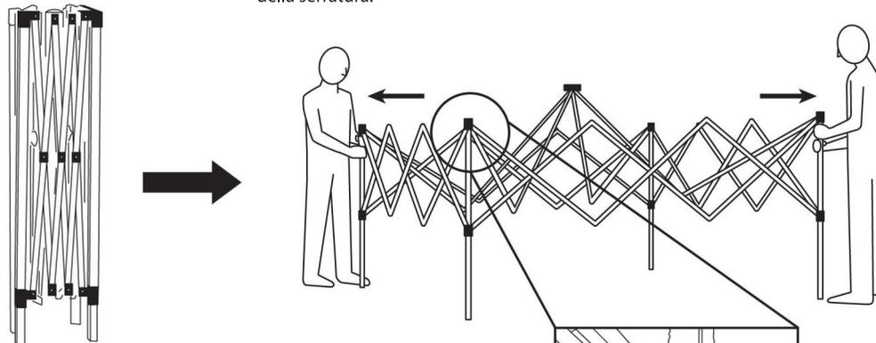
Dopo il montaggio del telaio, fissare saldamente la serratura nella buca della serratura, porre il soffitto sul telaio, il passo finale è di apporre le corde di guida ai quattro angoli della tenda. Tirare fermamente le corde di guida e legarle ai pali, poi martellare i pali nel terreno per ancorare la tenda in posizione.
