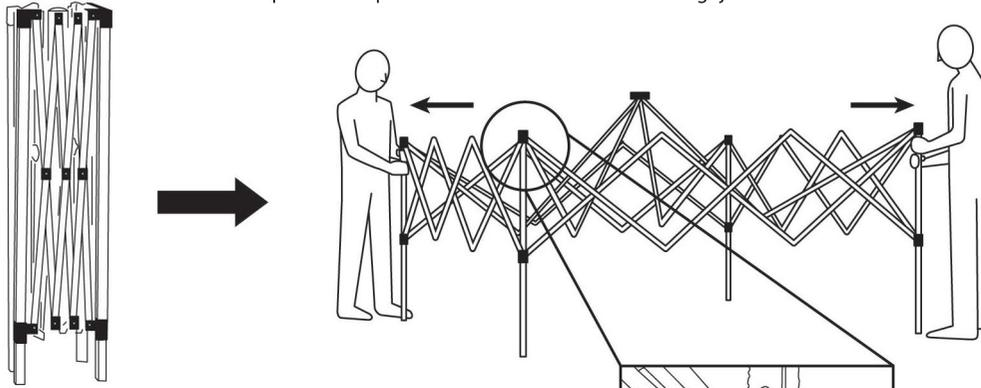
Instalar el techo a la estructura.
