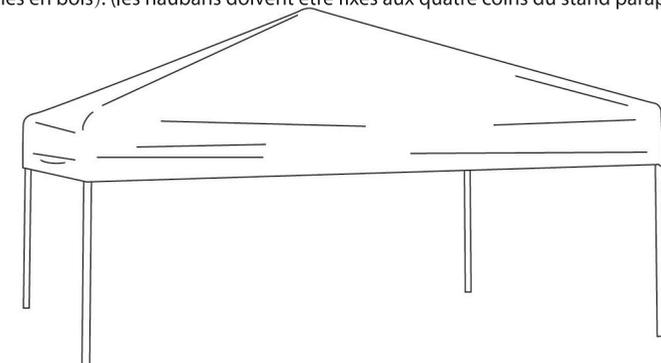
Poser la toile du plafond de la tente sur structure du stand parapluie avant de monter les piliers au maximum.
